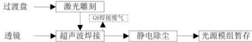
图 3-5 光源模组组装工艺流程图
