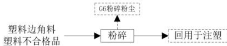
图 3-6 灯壳等配件生产工艺流程图
